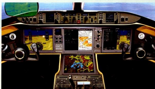
Пример кабины летательного аппарата с МФИ и HUD-дисплеем
