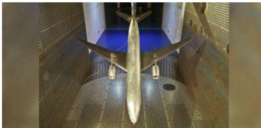
Модель самолета в аэротрубе /©ЦАГИ
