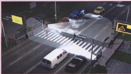
Модель использования средств освещения, работающих при системе КОМИССАР на 156 км автомобильной дороги
