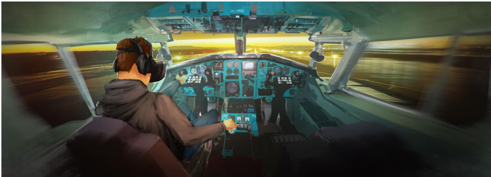
В кабине пилотов, рядом с креслом командира воздушного судна размещены очки виртуальной реальности, оснащенные наушниками. Сев в кресло и надев очки, пользователь переносится в виртуальную кабину самолета ТУ-144 с отрисованной панелью приборов, рычагом управления мощностью двигателя, штурвалом и т.д.. Причем местонахождение, например, штурвала, в виртуальном и реальном пространстве совпадают. Далее голос диктора предлагает начать виртуальный полет следуя голосовым инструкциям.
