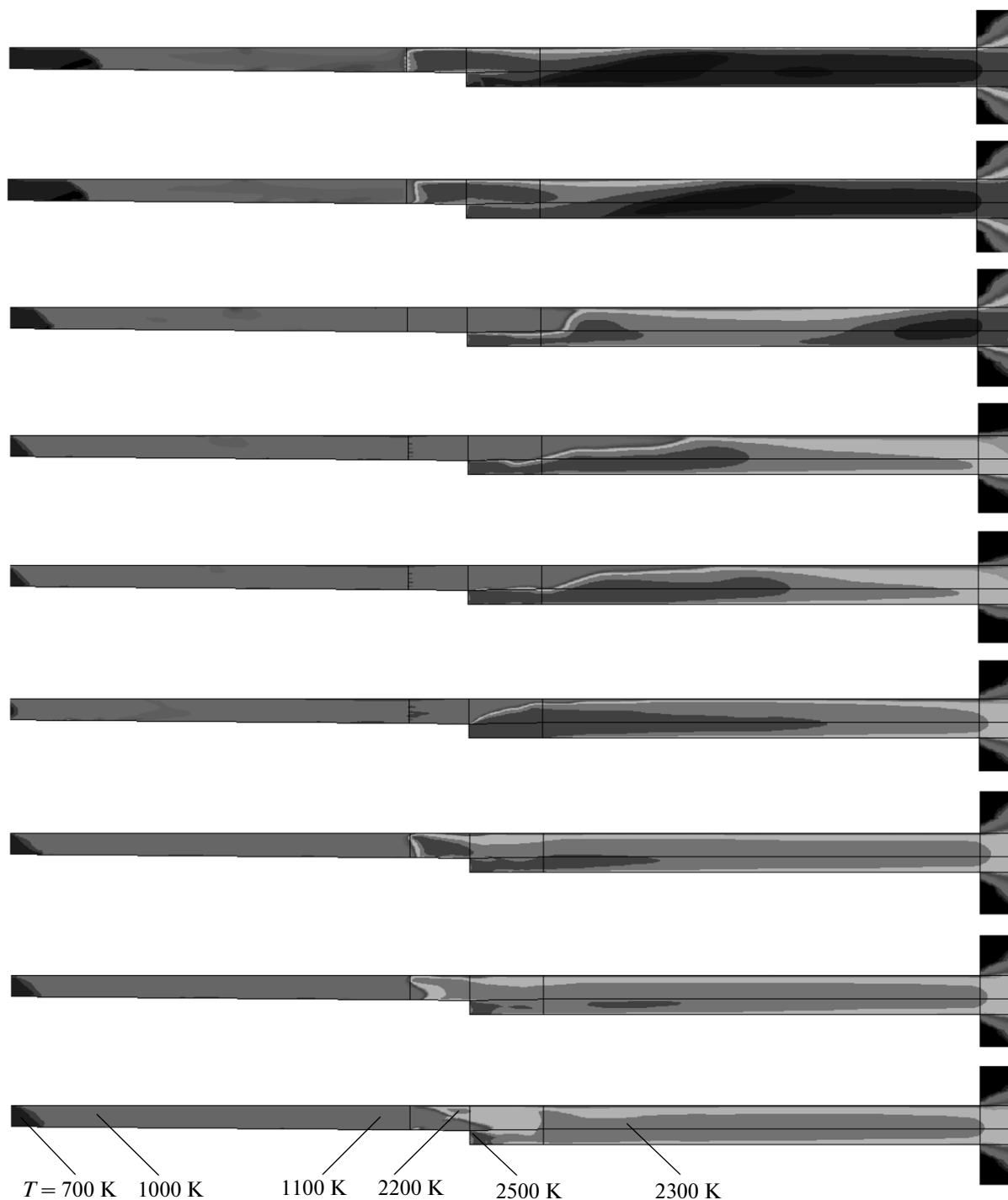
Рис. 7. Один цикл колебаний фронта пламени в расчете с локальным шагом по времени при температуре стенки T_w = 1000 К. Поля температуры в последовательные моменты времени.
