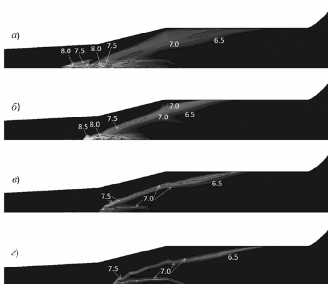
Рис. 8. Осредненные по времени поля десятичного логарифма скорости тепловыделения \phi , полученные для разных режимов течения в плоском канале: a - \alpha \approx 0.6 ; b - \alpha \approx 1.0 ; c - \alpha \approx 1.2 ; d - \alpha \approx 1.5
