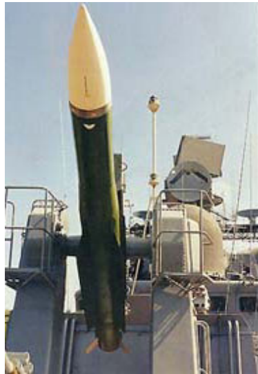
Пусковая установка ЗРК М-22 с ЗУР 9М38
