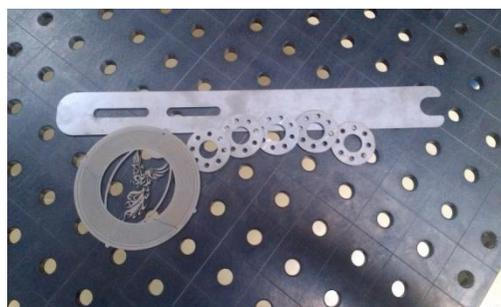
Примеры изделий, изготовленных на LaserCut - 6020 без дополнительной механической обработки
