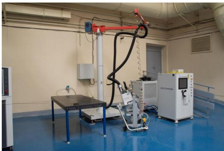
**Модуль ручной лазерной клещевой сварки с ЛС-2**
