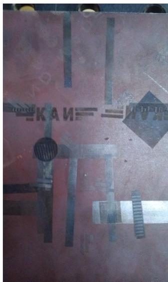
Пример портативной, ручной лазерной очистки и маркировки. Материал сталь 40. Загрязнение – ржавчина.
