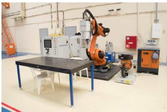
Технологический сварочный модуль клещевой сварки
