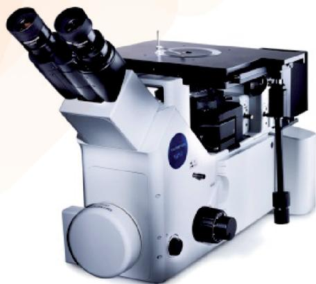
Позволяет оценить микроструктуру сечения материала. Определяет коэффициент наполнения композиционных материалов.
