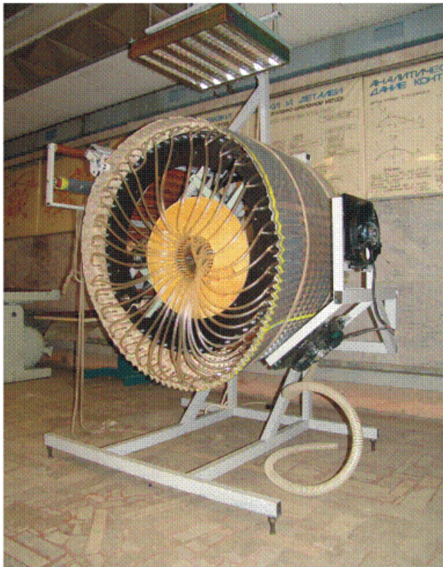
Установка для циклического формования z-гофра из препрегов (стекло-, органо-, углепластиков)
