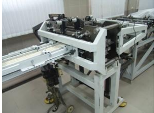
Установка для циклического формования z-гофра из бумаги Nomex
