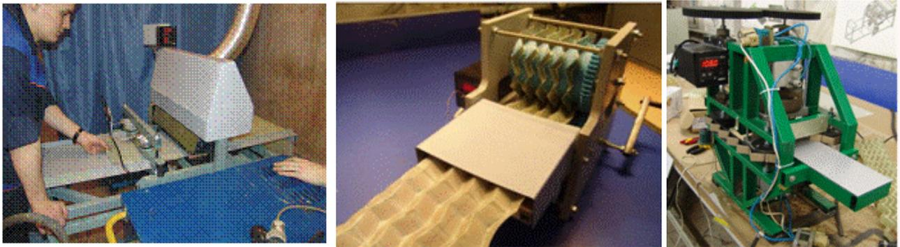
Установка поточного процесса калибровки и полимеризации z-гофра
