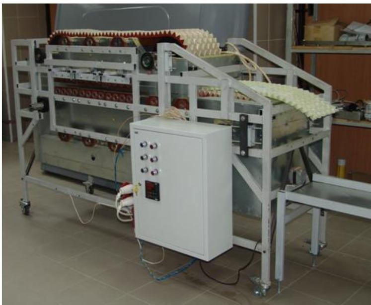
Установка для синхронного складывания z-гофра из листовых материалов
