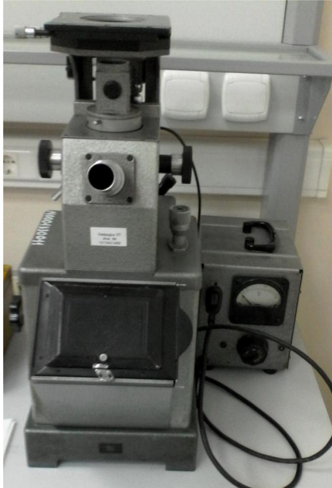
Микроскоп МИМ-7 предназначен для наблюдения и фотографирования микроструктуры металлов в обыкновенном свете в светлом и темном поле и в поляризованном свете в светлом поле. Набор объективов и окуляров обеспечивает увеличение микроскопа от  $60^{\times}$  до  $1440^{\times}$  при визуальном наблюдении и от  $70^{\times}$  до  $1350^{\times}$  при фотографировании.
