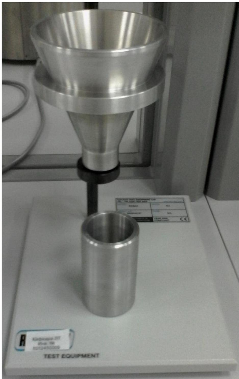
Устройство позволяет определять объемный фактор, насыпную плотность, а также сыпучесть пластиковых материалов таких, как порошки для прессования.
