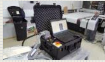
Система неразрушающего контроля на базе шерографа ISISmobile 3100
