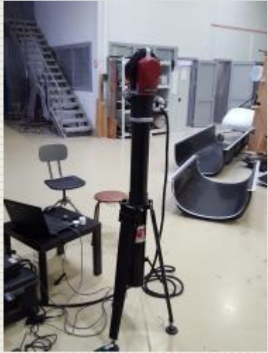
Координатно-измерительная лазерная система на базе лазерного трекера API Tracker Radian
