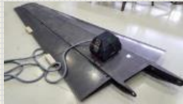
Система неразрушающего контроля на базе шерографа ISISmobile 3100
