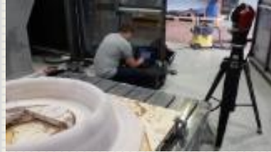
Координатно-измерительная лазерная система на базе лазерного трекера API Tracker Radian
