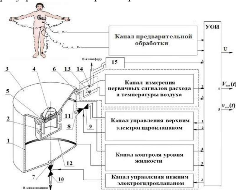
Рис.1. Концепция структурного построения устройства для измерения параметров уродинамики и уростатики мочевыделительной системы [4] наружный стакан; 2 – внутренний стакан; 3 – датчик первичных сигналов расхода воздуха и температуры; 4 – воронка; 5 – сливное отверстие; 6 – обтекатель; 7 – разделитель потока; 8 – первый электрогидроклапан; 9 – отверстие для вытеснения воздуха; 10 – отверстие для заполнения жидкостью; 11 – нижний электрод емкостного датчика; 12 – верхний электрод емкостного датчика; 13 – второй электрогидроклапан; 14 – компенсационный анемочувствительный элемент; 15 – измерительный анемочувствительный элемент; 16 – датчик атмосферного давления; 17, 19 – каналы управления соответственно верхним и нижним ЭГК; 18 – электроды емкостного датчика модуля самокалибровки; 20 – микроконтроллер обработки и формирования выходной информации.
