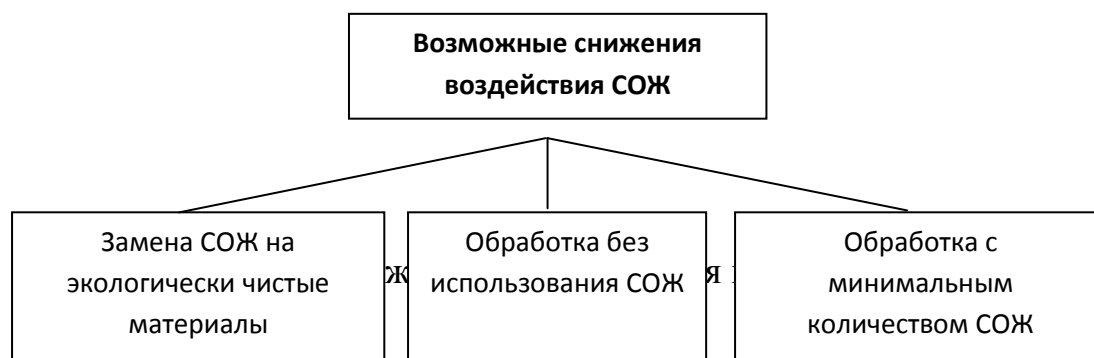
Рис. 1. Возможные пути снижения воздействия СОЖ на человека и биосферу
