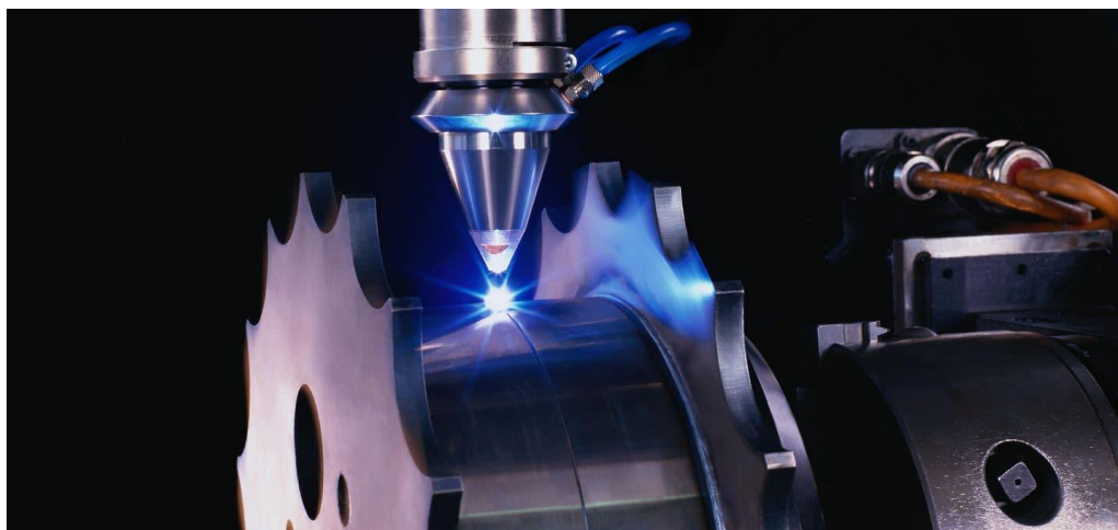
Рисунок 7 – Лазерная сварка металлов
