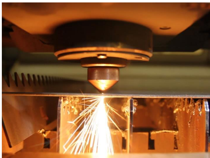
Рисунок 6 – Лазерное сверление металлов
