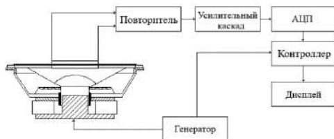
Рис. 1. – Структурная схема установки для измерения пьезомодуля пленки ПВДФ.
