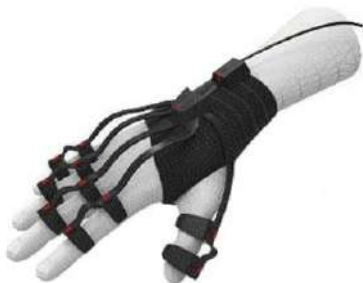
Рис. 1 – Представление реализации интеллектуальной перчатки
