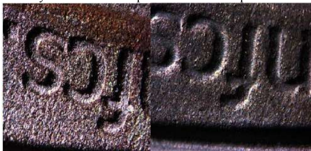
Рис. 3. Поверхности детали до(слева) и после(справа) полировки 3. Заключение
