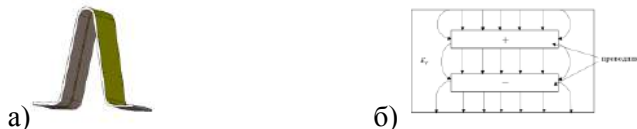
Рис. 1. Модель исследуемой элементарной ячейки: а) электродинамическая компьютерная модель; б) эквивалентный вариант, используемый при математическом моделировании
