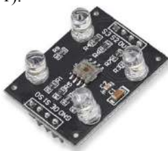
Рис. 1 – Датчик оттенка цвета TCS3200.
