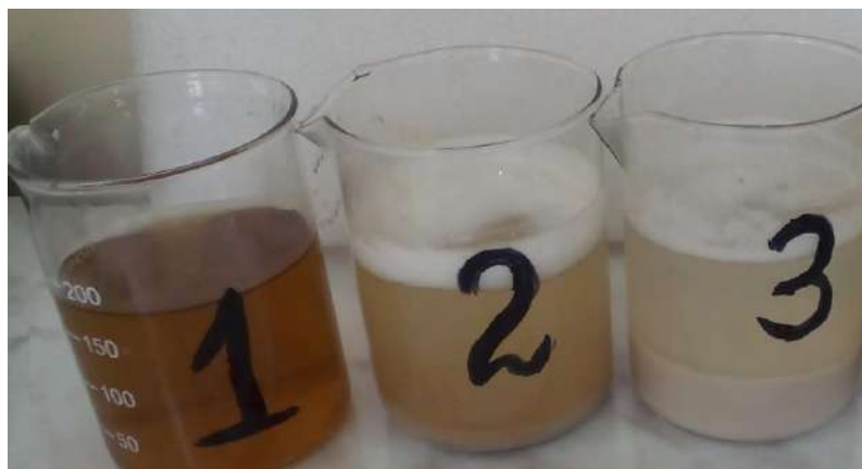
Рисунок 4 – Результаты осветления фильтрата при совместном использовании коагулянта сульфат алюминия Al_2(SO_4)_3 и небольшой дозе Ca(OH)_2 1 - исходная проба; 2 и 3 – проба после совместного применения коагулянта Al_2(SO_4)_3 при небольшой дозе Ca(OH)_2
