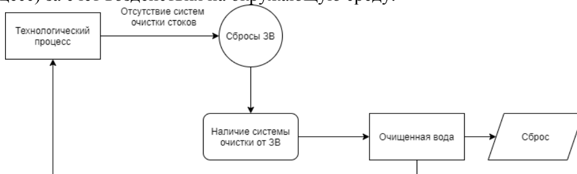
Рисунок 2 – Блок-схема схема очистки сточных вод гальванического производства с системой очистки
