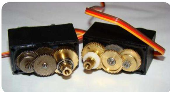
Рис. 5, 6 – Процесс переделки серводвигателей.
