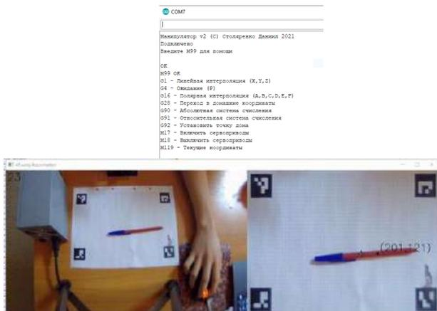
Рис. 9, 10 – терминал для ввода G-code команд и окно программы man2Vision.
