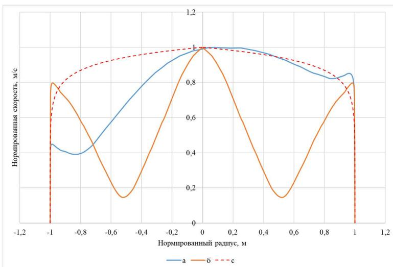
Рис. 3. Сравнение профилей скорости (а) вдоль подающей трубы, (б) поперек подающей трубы, (с) теоретический профиль скорости
