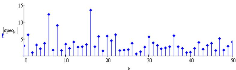
Рис. 3. Амплитудный спектр сигнала с шумом.
