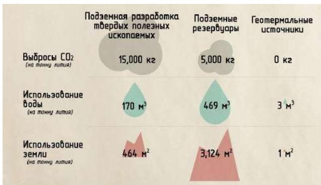
Рис. 2. Используемые ресурсы при различных методах добычи лития
