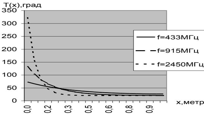
Рис. 1. График зависимости температуры нагрева диэлектрической среды от глубины, на разных частотах источника СВЧ.
