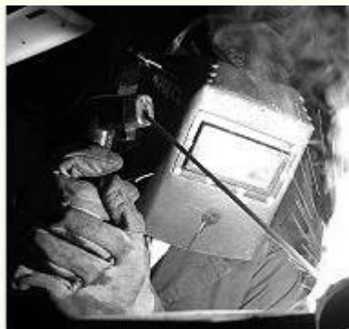
Электродуговая ручная сварка покрытым электродом
