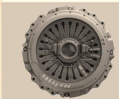
Сцепление с диафрагменной пружиной в сборе
